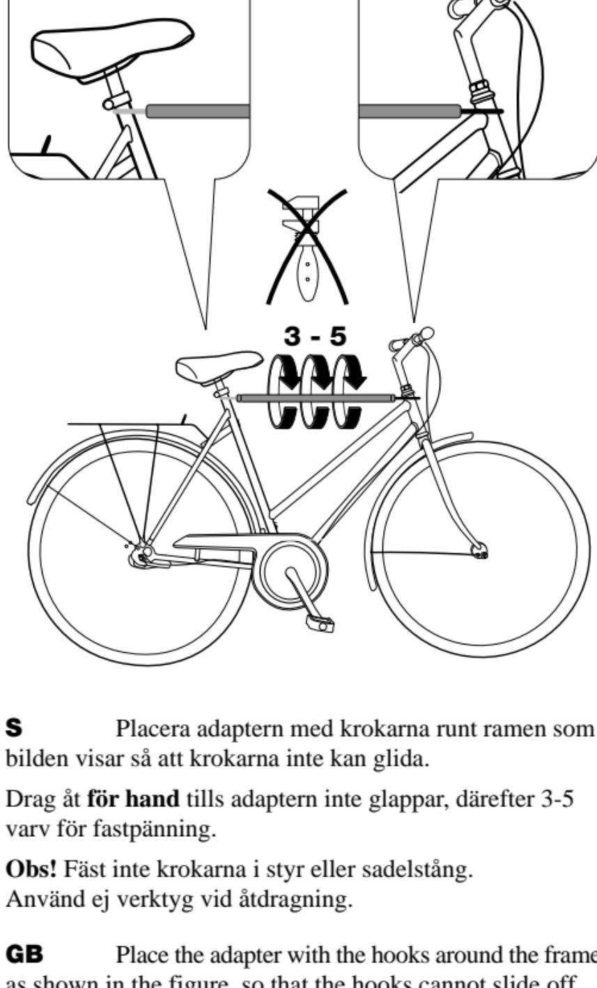
**S** Placera adaptern med krokarna runt ramen som bilden visar så att krokarna inte kan glida.
